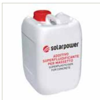
Additivo superfluidificante S-FLUID per massetto, ad azione deflocculante e con effetto ritardante sull'idratazione del cemento. L'additivo è una soluzione acquosa al 40% di polimeri attivi capaci di disperdere i granuli del cemento. La modulazione del dosaggio è compresa il tra 0.5÷1.5% rispetto al peso del cemento. L'additivo S-FLUID è disponibile in taniche da 25 kg ed è conforme alla norma UNI EN 934/2002.
