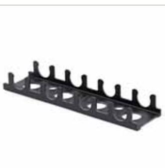
Profilo di fissaggio in materiale plastico per l'ancoraggio delle tubazioni su pannelli isolanti con superficie piana, interasse 50 mm, lunghezza 1 m, per tubo Ø 17x 2 mm e tubo Ø 20 x 2 mm, con biadesivo.
