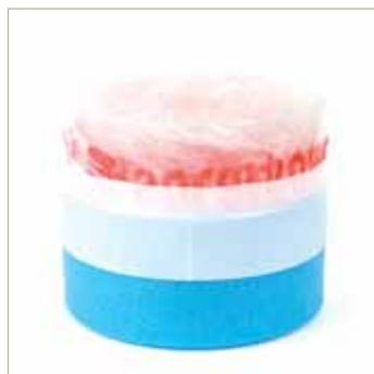
Striscia isolante pretagliata (a partire da quota 7 cm con intervallo di taglio pari a 1 cm) in schiuma morbida di polietilene adibita ad assorbire le dilatazioni del pavimento, ad isolare termicamente le pareti e a garantire la discontinuità acustica fra il pavimento e le pareti. Tale fascia è accoppiata ad un foglio adesivo in polietilene morbido e ad un foglio adesivo di LDPE destinato ad essere appoggiato sui pannelli isolanti per evitare infiltrazioni di malta tra cornice e pannello.
