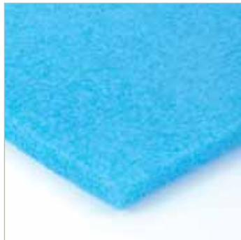
Tappeto FLEX isolante termoacustico flessibile, in polietilene espanso elasticizzato chimico a celle chiuse, disponibile in rotoli da 65 m<sup>2</sup>, conforme norma AFNOR NF F 16-101-1988 e alla UNI EN 826.
