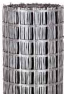
Rete stabilizzatrice in fibra di vetro con trattamento antialcali avente funzione di rinforzo del massetto, con maglia 40x40 mm, conforme alla norma UNI 9311 e UNI 8532, confezionata in rotoli di 50 m<sup>2</sup> e lunghezza 100 m.
