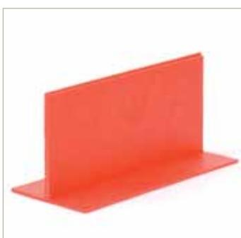
Giunto di dilatazione a doppia L in polietilene espanso accoppiato con doppio adesivo alla base: consente la dilatazione del massetto in corrispondenza dei giunti strutturali dell'edificio e nei casi di ampie superfici (consigliato nella realizzazione di pavimenti con superfici che superano i 40 m<sup>2</sup>, oppure con un lato superiore a 8 m).
