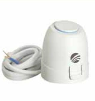
Testa termoelettrica 230 V (normalmente in posizione di chiusura - con tensione apre), tensione di alimentazione 230 VAC, cavo di alimentazione 2 fili o 4 fili x 0,75 mm<sup>2</sup>, lunghezza 1000 mm. La testa termoelettrica deve essere collegata esclusivamente a termostati o cronotermostati di tipo on-off. Non utilizzare termostati o cronotermostati a 3 punti o modulanti.
